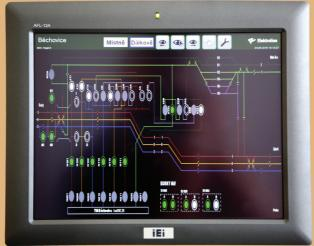
Možnost rozšíření o dotykovou obrazovku pro snadné místní ovládání, včetně zobrazení schémat napájení a dělení a také vizualizace stavů jednotlivých odnojovačů
