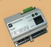
moduly T05Dp a T03Dp. Obsahuje 2 zdroje 24 VDC, kde jeden je pro napájení samotných modulů, přes druhý je napájeno ovládací napětí binárně řízeného modulu, pokud je využito. Zdroj obsahuje přepínač MÍSTNĚ / DÁLKOVĚ včetně signalizačních kontaktů a hlášením ztráty napětí. Velikost zdroje je 6 modulů DIN.
