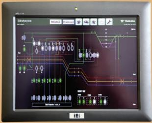
Możnost rozśiření o dotykovou obrazovku pro snadné místní ovládání, včetně zobrazení schémat napájení a dělení a také vizualizace stavů jednotlivých odpojovačů.
