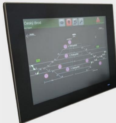
Elektroline provádí výrobu a montáž systému DOOS, zařízení určeného pro místní a vzdálené ovládání, regulaci a vyhodnocování stavů osvětlení, elektrického ohřevu výhybek a dalších technologických zařízení.
